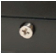
Protección activada (tornillo salido o quitado)
