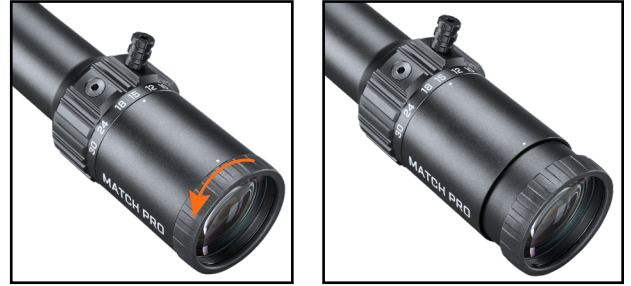
Der Diopter ist werkseitig ganz nach innen gestellt und lässt sich daher anfangs relativ zu der oben links dargestellten Orientierung nur gegen den Uhrzeigersinn drehen.
