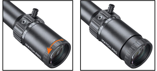
La regolazione diottrica è impostata in fabbrica completamente verso l'interno, quindi inizialmente ruoterà solo in senso antiorario rispetto all'orientamento mostrato sopra a sinistra.
