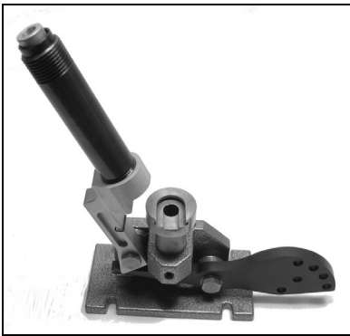
Install Primer Shield
